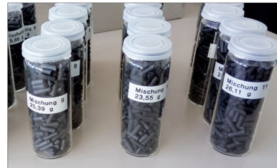
Abb. 1: Komposit-Aktivkohle (holzkohlebasiert, 20 % Graphit, Binder: Palatinose) © Fraunhofer-Institut für Umwelt-, Sicherheits- und Energietechnik UMSICHT
