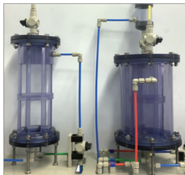
Abb. 2: Rohrreaktoren im Labormaßstab; links: mikrobielle Brennstoffzelle im Einkammersystem; rechts: mikrobielle Elektrolysezelle im Zwei-Kammer-System (© EnviroChemie GmbH).
