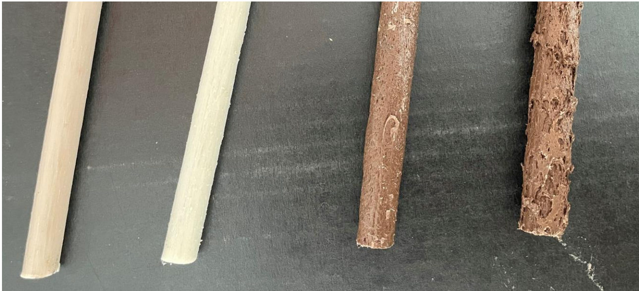
Abbildung 24: Extrudierte Profile Up-scaling 1 (von links nach recht: 100 % V 233110; 80 % V 233110 + PLA; 80 % V 233110 + PLA mit zu geringer Rauigkeit; 80 % V 233110 + PLA mit zu hoher Rauigkeit)
