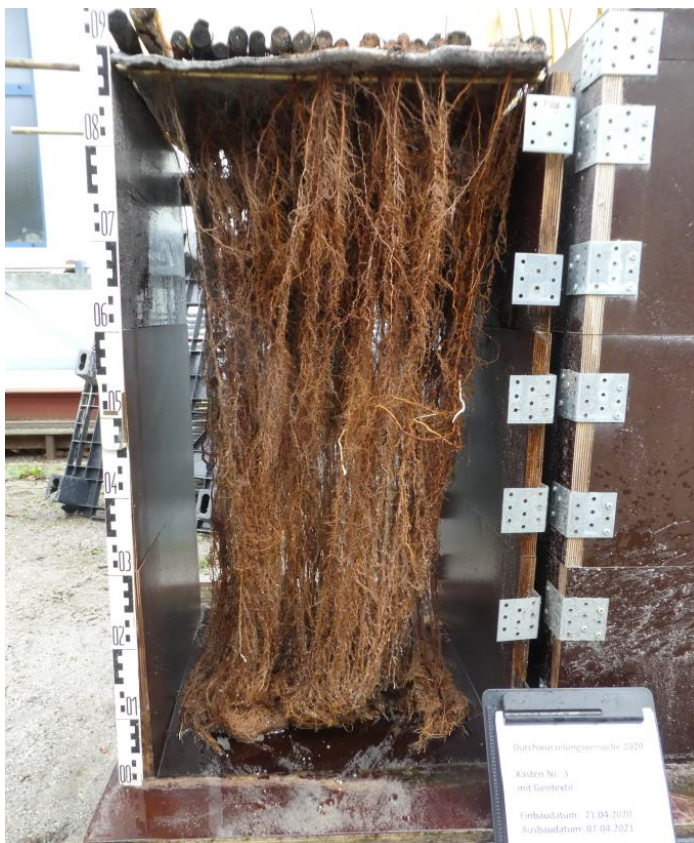
Abbildung 8: Freigespülte Wurzeln einer Weidenspreitlage (eingebaut im Versuchskasten auf dem Geotextil)
