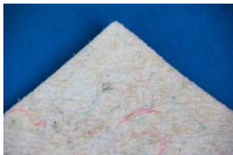
**Abbildung 3: Geotextilprototyp Variante A**
