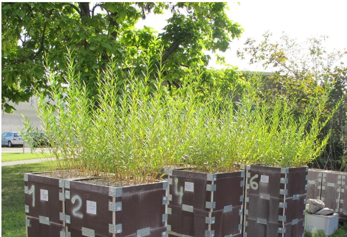
**Abbildung 21: Entwicklung der Weiden in den Versuchskästen am 09.08.2019 (eingebaut am 27.3.2019); Kästen 1 – 3 mit Geotextil; Kästen 4 – 6 ohne Geotextil**
