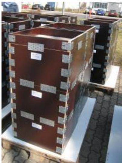
**Abbildung 14: Beispielhafte Pflanzkästen für die Tests auf Durchwurzelbarkeit**
