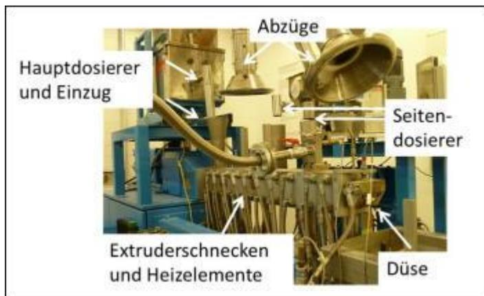
**Abbildung 5: Doppelschneckenextruder mit Seitendosierung**
