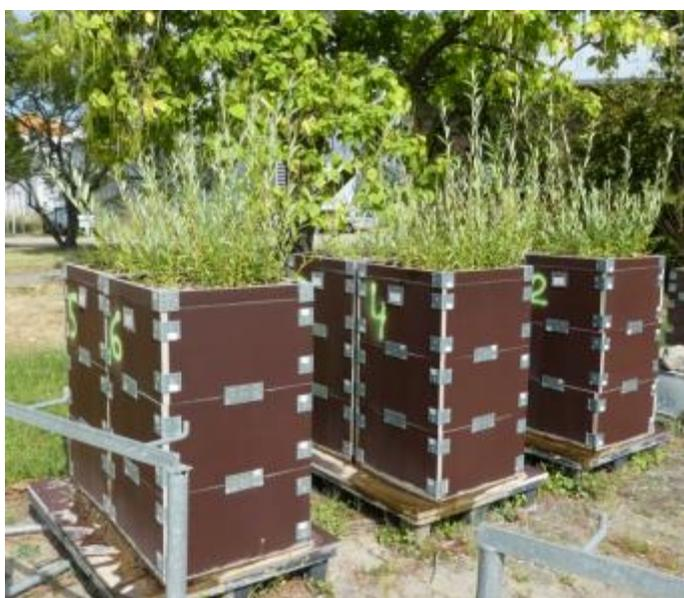
**Abbildung 17: Versuchskästen am 23.8.2018 (3 Monate nach Einbau) – Kasten 1 bis 3 mit Geotextil, Kasten 4 bis 6 ohne Geotextil**
