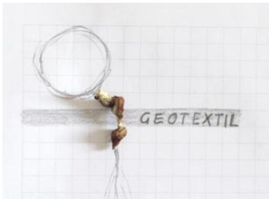
Abbildung 24: Wurzelform nach Durchdringen des Geotextils
