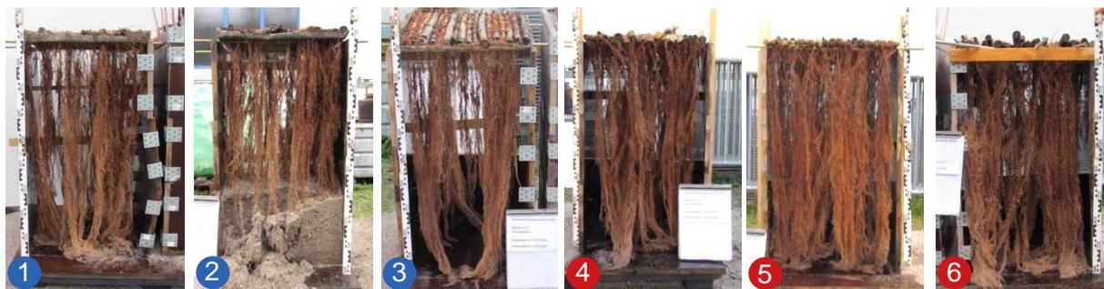
**Abbildung 21: Freigespülte Wurzeln; Kästen 1 – 3 mit Geotextil; Kästen 4 – 6 ohne Geotextil**
