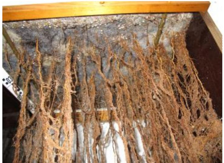
**Abbildung 19: Auswertung Kasten 1 (mit Geotextil): Freigespülte Wurzeln, oberirdische Sprosse wurden vorher abgeschnitten und vermessen, links: die verlegten Äste sind noch über dem Geotextil vorhanden, rechts: Blick auf die Unterseite des Geotextils – Wurzeln durchdringen von oben das Geotextil**
